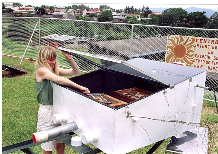
Fig. 9c. Secador solar tipo activo (parcialmente) con un abanico (parte atrás).
