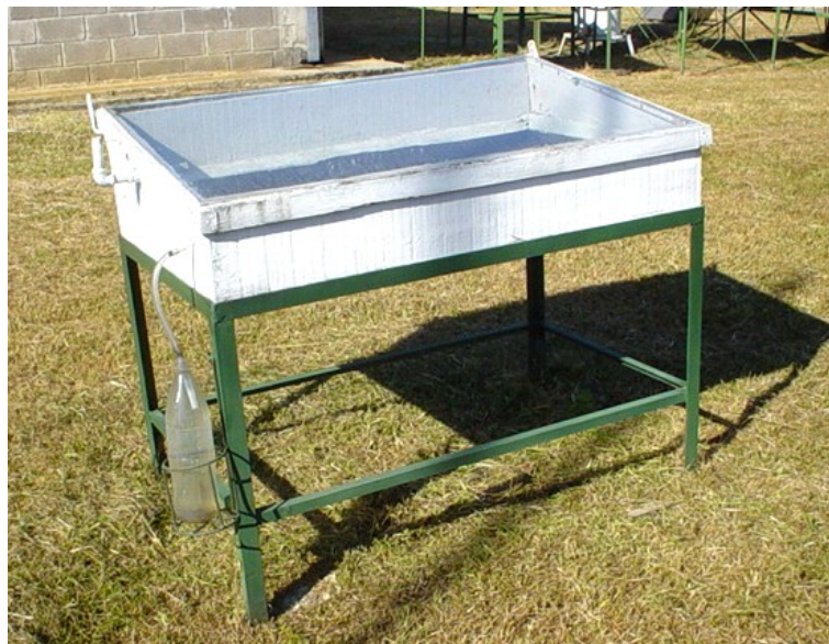
Fig. 10b. Un Destilador solar con una àrea de 1 m 2 .
