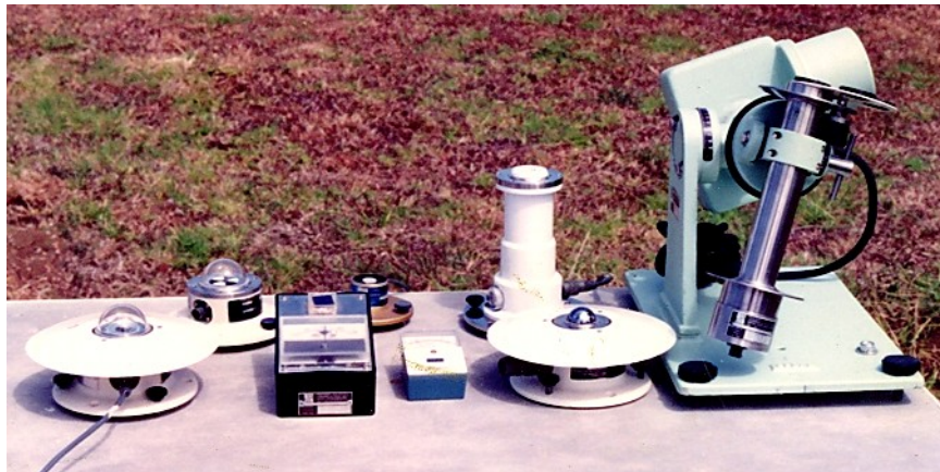
Fig. 1 a. Instrumentos para medir diferentes tipos de Radiación solar- Global, Directa y Ultra Violeta.
